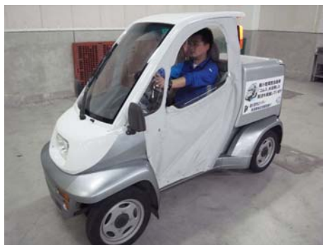
今回使用する電気自動車は「トヨタ コムス」。 1人乗りの超小型タイプで、最高速は50km/h。
