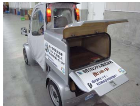
1回の充電で約45km走行できます。荷室は後部に2段。積載量は30kgまで。
