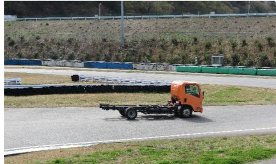
今回の試験走行では、廃棄予定であった2012年式いすゞ2tエルフを使用しました。IAT社およびヤマト・インダストリー社が、当該車両のディーゼルエンジン部分を2台のバッテリー（合計84kwh）とモーターに換装しEV先行試作車に改造。荷台を取り外した状態でサーキットコースを周回しながら走行性能や安全性の検証を行いました。
