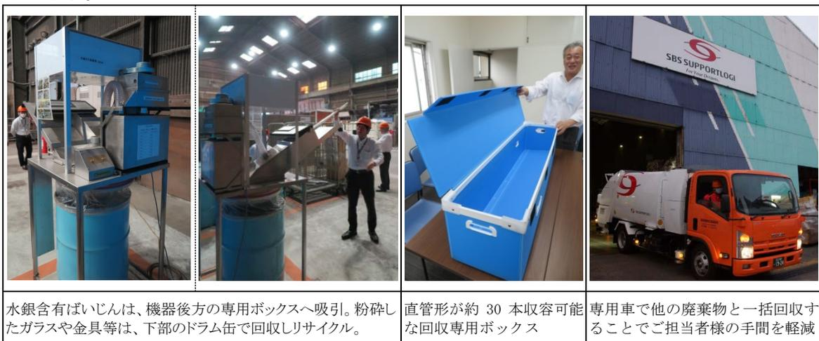
水銀含有ばいじんは、機器後方の専用ボックスへ吸引。粉砕したガラスや金具等は、下部のドラム缶で回収リサイクル。
