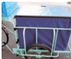
これがリヤカー部分。振動で商品が破損しないよう、ケースはウレタン素材です
