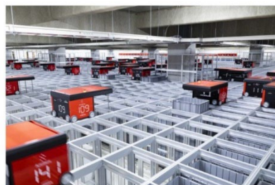
SBS リコーロジスティクスの「物流センター横浜東区店」では、自動倉庫システム「AutoStore（オートストア）」を ASEAN 地域で大規模の導入し生産性をあげている。
